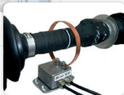
Sensoren für Drehzahl und Drehmoment an einer Antriebswelle
